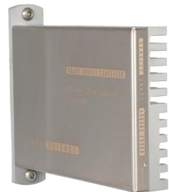
Konvertiert die Bremsenergie in Wärme damit diese nicht die Netzteil-spannung anhebt und die Funktion des Netzteils nicht beeinträchtigt. Nutzbar für Netzteile von 24 -72 VDC. Bis zu 3 Servocontroller anschliessbar. Ppeak 500W.
