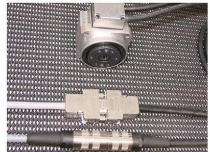
Die Verlängerungskabel der Drehachse sind identisch zu den Verlängerungskabeln bei den LINAX® Lxc / Lxe Linearmotor-Achsen.
