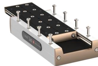
Die sehr kompakten Abmessungen lassen nur wenig Raum für die Verschraubung zu. Deshalb sind bei den Lxc Achsen Schrauben mit niedrigem Kopf eingesetzt. Werden normale Inbusschrauben verwendet, dann stehen diese vor und können bei Kreuztischanordnungen verkleben.
