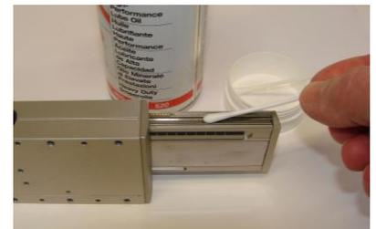
Dazu am einfachsten mit einem fettgetränkten Wattestäbchen die Laufstäbe an allen zugänglichen Stellen benetzen und darauf achten, dass dabei der Glasmasstab trocken bleibt, sonst diesen anschliessend reinigen.
