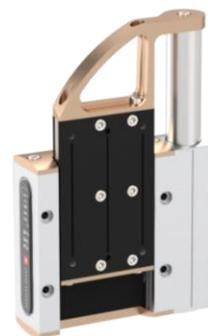
Bei Stromunterbruch ist der Linearmotor der LINAX® Linearachsen kraftlos. Wird die Achse vertikal eingebaut, so fällt der Schlitten nach unten. Mit dieser rechtsangebauten Gewichtskompensation für die kleinste LINAX® Linearmotorachse, basierend auf Federkraft, bewegt sich der Schlitten nach oben bei Stromunterbruch. Sie kann mit 4 unterschiedlichen Federn bestückt werden für externe Lastgewichte von **0-200g, 200-400g, 400-600g und 600-900g**.
