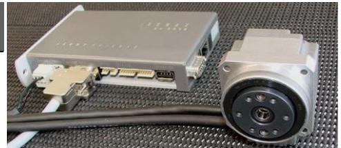
3 Phasen Servomotor 10polig mit spielfreiem Getriebe 1:30
